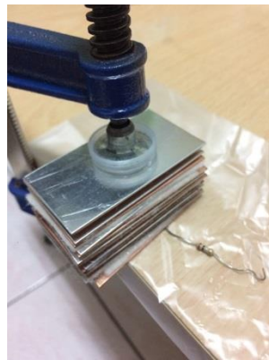
照片 6 鋁-銅電極的環保電池串聯接線方式
